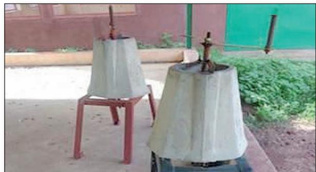
Photo 6 : DFBP/ORIGINELLE : Décortiqueuse tronconique type FullBellyProject Originelle utilisée au niveau de la plateforme de production énergétique de Teriya Bugu.
