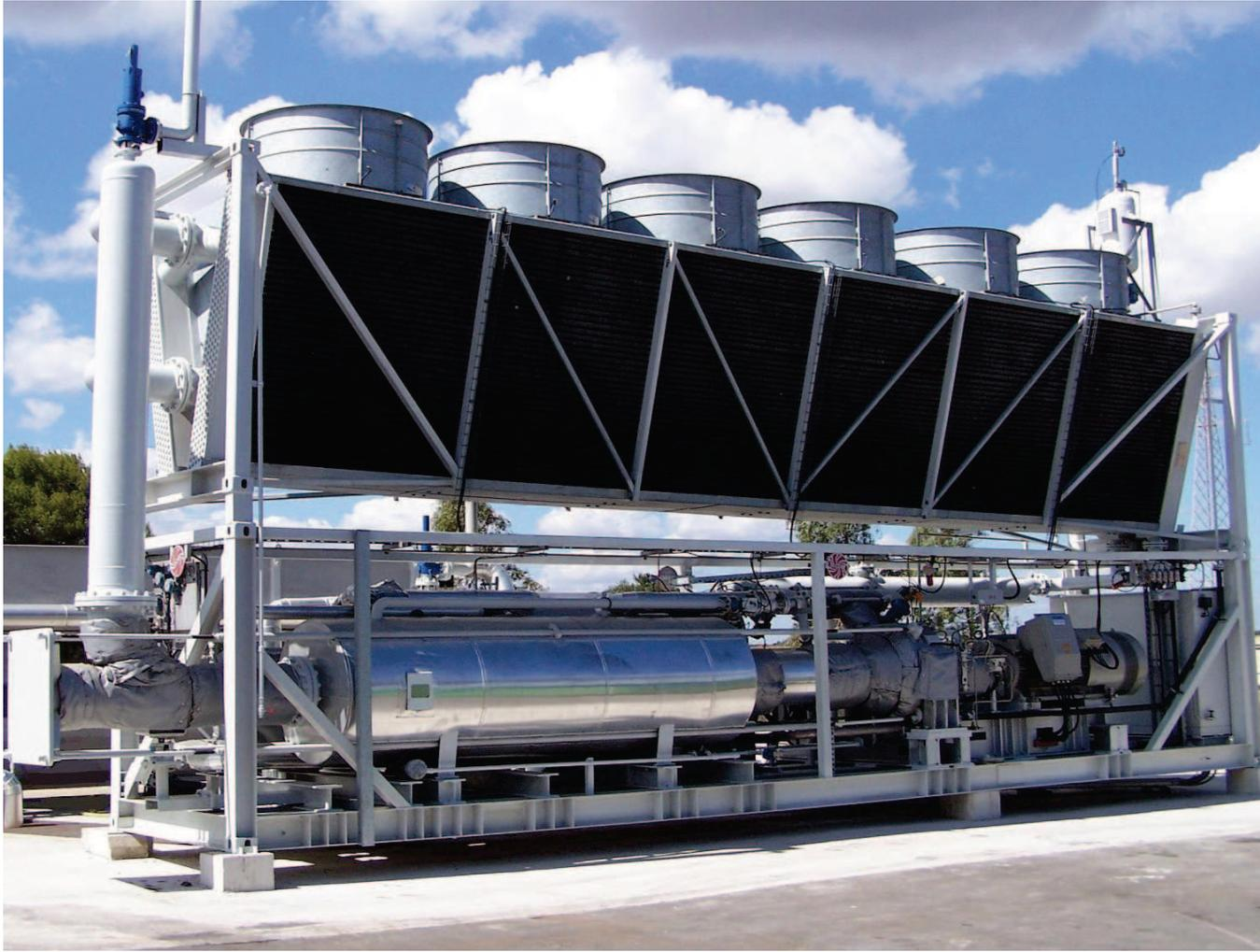
Cette technologie est considérée comme une alternative aux cycles de vapeur conventionnels avec une turbine, mais utilisant cette fois un fluide organique (huile organique) comme fluide de travail en lieu et place de l'eau. Les turbogénérateurs ORC permettent la production d'électricité avec de bons rendements dans des unités de cogénération de faible capacité et avec des applications thermiques à basse température (eau chaude).
