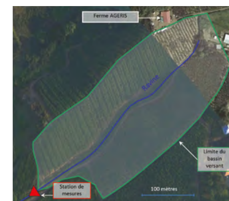
Périmètre de suivi des impacts sur un périmètre réduit à un micro-bassin versant (Source : SYNGENTA – site internet)
