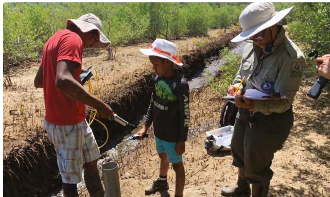
Détermination de la salinité, du potentiel redox, du pH et de la température de l'eau interstitielle dans une forêt d'*Avicennia germinans* sur un site en Amérique Centrale.
