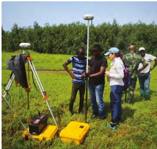
Figure 19. Détermination du niveau topographique avec la méthodologie RTK au Bénin (photo ci-dessus) et distribution microtopographique d'une forêt de mangrove dégradée sur un site de Cuajiniquil, Costa Rica, 2018 (photo page p47).
