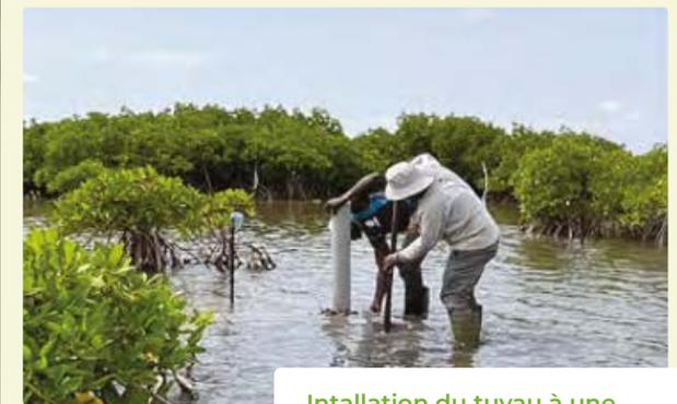
Installation du tuyau à une profondeur où la biomasse racinaire est maximale
